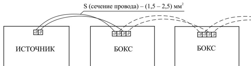
Рисунок 2 – Схема подключения боксов к источнику
