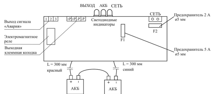
Рисунок 5 – Схема подключения платы БР24
